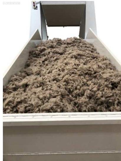
Die komplette Anlage wurde so konzipiert, dass ein einziger Arbeiter die Mischungen zusammensetzt und die gesamte Haaraufbereitung bearbeiten kann. Er wird in der Lage sein, - wie gewünscht – 400 bis 800 kg Haarmaterial innerhalb von 8 Stunden zu behandeln.
