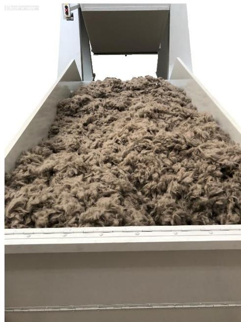
La instalación completa ha sido diseñada de tal manera que un solo operador reúne las mezclas y opera toda la preparación del pelo. Será capaz de manejar - como se desea - 400 a 800 kg de material capilar en 8 horas. La información sobre los arreglos posibles y el espacio requerido, se dan a petición.
